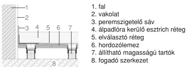
1.6 Álpadlóra kerülő esztrich sematikus ábrája
