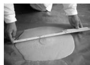
3.22 A önterülő esztrich réteg képlékenységének mérése – területmérés (39–42 cm)
