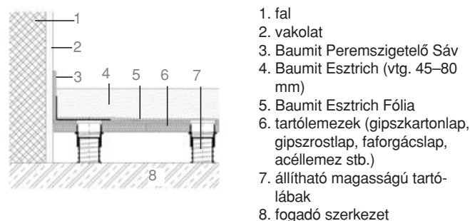
2.6 Tartólábakon álló álpadlóra kerülő cementesztrich sematikus ábrája
